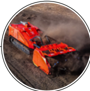
DOK-ING MV-10 Роботизована система для розмінування.
