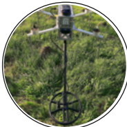
ST1 Автоматичний дрон для пошуку мін.
