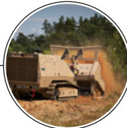
GSC-200 Машина механізованого розмінування.
