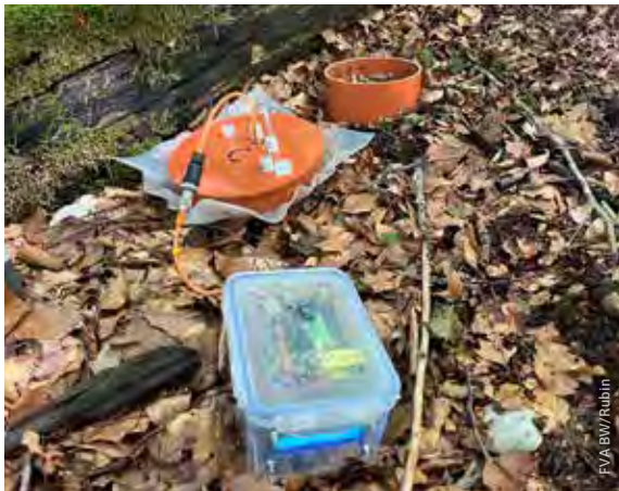
↑ Kammermessung zur Erfassung der Bodenatmung
