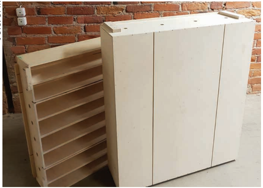
Ящики из березовой фанеры, которые будут использоваться для строительства двухслойного „термоса“ СПГ-терминала, который затем будет покрыт листовым металлом.
