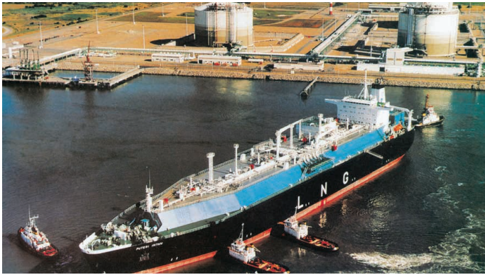
СПГ-терминал вместимостью 120 000-140 000 м 3 сжиженного природного газа. Для изготовления стенок корпуса внутри судна использовалась фанера из эстонской березы.
