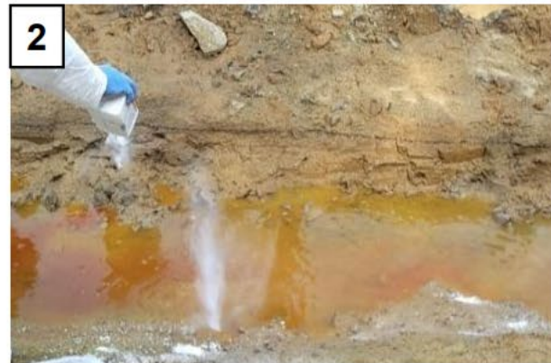
Дослідження, яке проведено MuniRem Environmental. 1. Досліджувана вода до забруднення; 2. та 3. Забруднення води динітротолуолом
